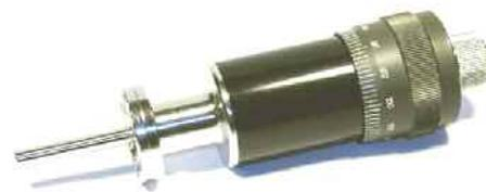
Magnetische Drehdurchführungen bieten deutliche Vorteile gegenüber den mechanischen. Sie sind ohne Balg gefertigt und daher auch bei Dauerbetrieb unverwüstlich. Eine eingearbeitete Nut erlaubt die einfache Adaption an motorisierte Antriebe.
