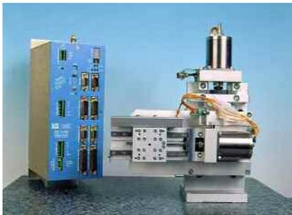
Präzisions-X-Y Tisch mit 25 mm Verfahrweg und einer Auflösung von 2.5 µm pro Halbschritt. Mit dem optional erhältlichen 500-Schritt Motor wird eine Auflösung von 1 µm pro Halbschritt erreicht. Vakuum spezifikation: > 10<sup>7</sup> mbar. Programmierbarer zwei-Achsen Controller
